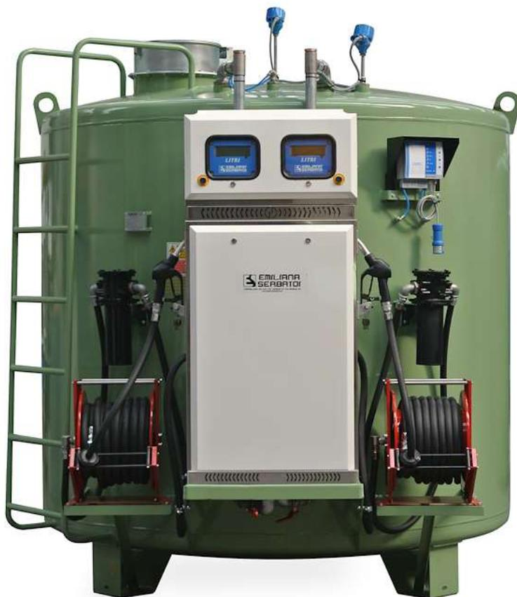
Цилиндрические вертикальные двустенные резервуары имеют выпуклые днища, изготавливаются из каландрированной листовой углеродистой стали S 235 JR в соответствии со стандартами UNI EN 10025. Резервуары оснащены шкафами с заправочным оборудованием или ТРК.
