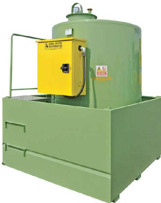
Цилиндрические вертикальные одностенные резервуары имеют выпуклые днища, изготовлены из каландрированной листовой углеродистой стали S 235 JR в соответствии со стандартами UNI EN 10025. Резервуары оснащены поддонами, вместимостью 50% или 100% от номинального объема резервуара. Резервуары также оснащены шкафами с заправочным оборудованием или ТРК.
