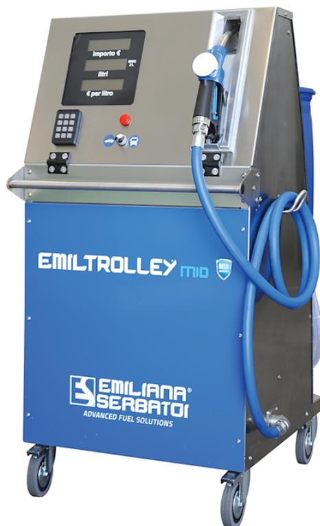
Передвижная электрическая система заправки для отпуска AdBlue®, рассчитана на использование в коммерческих целях с бочками на 60 или 200 л. Оснащена электронным счетчиком-расходометром последнего поколения (сертифицирован в соответствии с Директивой по измерительным приборам), самозаливающимся насосом с реле давления, позволяющим регулировать расход жидкости на выходе (5 или 15 литров в минуту), неинтрузивным датчиком минимального уровня и электронными устройствами защиты и управления.
