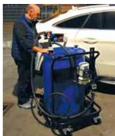
Тележка с насосом 220 V, производительностью 30 л/мин, 4 м кабелем с зажимами для аккумулятора, автоматическим пистолетом ZVA подходящим для заправки автомобилей с функцией дозирования 5-10 л с помощью регулирующего ключа) и 3 м шлангом из EPDM. В наличии также электронный расходомер модель K24.
