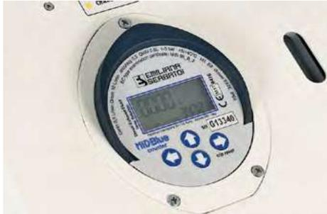
Высокоточный цифровой счетчик-расходомер с овальными шестернями, сертифицированный в соответствии со стандартом MI-005, установленным Европейской директивой по измерительным приборам 214/32/EU. Возможность просмотра данных по каждому отдельному отпуску (количество, дата/время, порядковый номер) и занесения в память до 2000 операций, к которым легко можно обратиться для последующего контроля или проверки.
