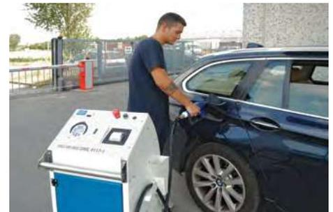
Передвижная электрическая система заправки для отпуска AdBlue®, предназначена для бочек на 60 или 200 л, со счетчиком-расходомером, сертифицированным в соответствии с Директивой по измерительным приборам MI-005 для использования в коммерческих целях.
