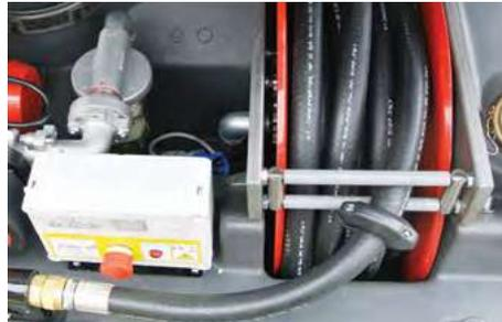
Электрический щит и катушка с пружинным приводом.
