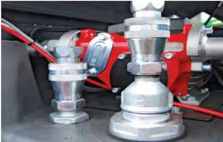
N.2 быстроразъёмных соединения 1/2" для подключения к генераторной установке (прямая + обратная топливная магистраль + всасывающая труба).
