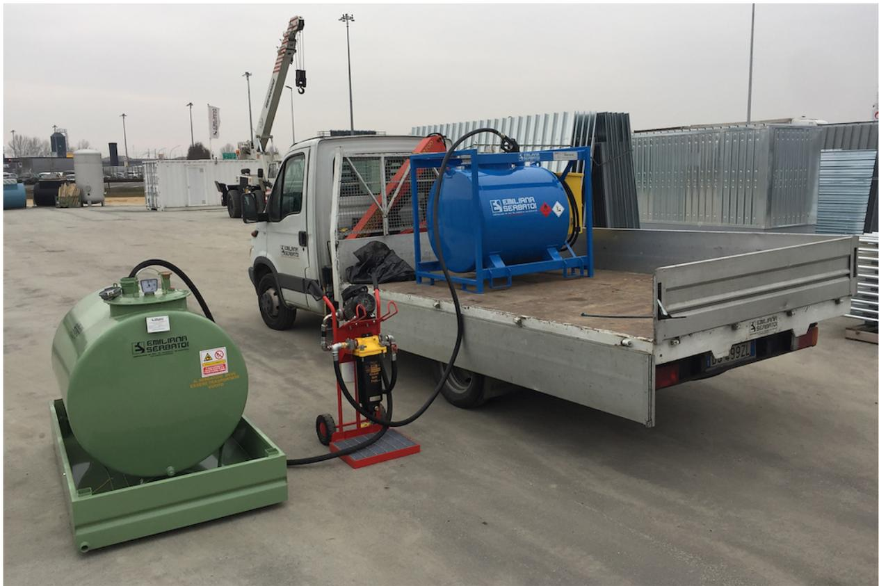
**EMIL-FILTER: Мобильная установка для очистки топлива и очистки резервуаров (Фильтр тройного действия)**
