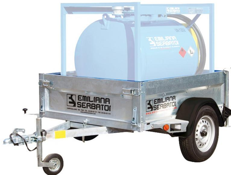
Speedytank это бортовой прицеп, подходящий для автотранспортных перевозок, к которому быстро крепятся наши мобильные резервуары; соответствует требованиям ДОПОГ.
