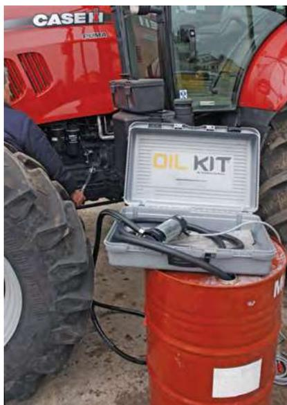
Переносная установка для перекачивания масла, укомплектованная насосом с питанием от аккумуляторной батареи и электродвигателем на 12 В или 24 В постоянного тока.
