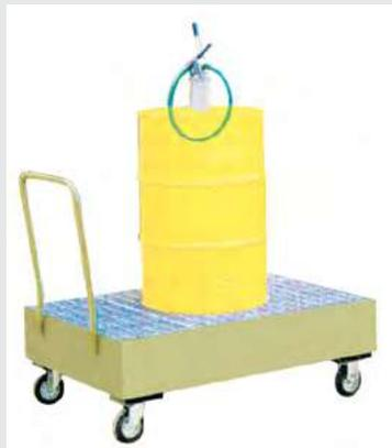
Поддоны изготовлены из листовой углеродистой стали в соответствии со стандартами UNI EN 10025, оснащены стальной оцинкованной легко снимающейся решеткой и сливной пробкой для облегчения чистки, могут устанавливаться на любую поверхность, модельный ряд варьируется в зависимости от объёма бочек.
