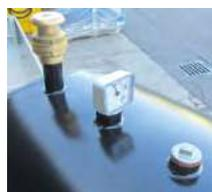
Механический уровнемер и фильтр на основе активированного угля.
