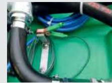
Кабель заземления с зажимом. Grounding cable with clamp.
