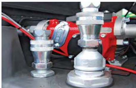
N.2 быстроразъёмных соединения \frac{1}{2} " для подключения к генераторной установке (прямая + обратная топливная магистраль + всасывающая труба). n. 2 rapid couplings, size \frac{1}{2} ", for generator sets connection (feeding + return line+ suction pipe).
