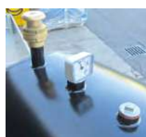
Механический уровнемер и фильтр на основе активированного угля. Mechanical level gauge and activated carbons vent filter.
