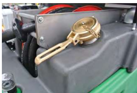
Заливная горловина 2". Filling quick cap 2".
